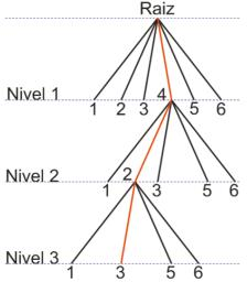
Figura 3: Exemplo de busca em profundidade com o método do gradiente (trajetória otimizada em vermelho).
